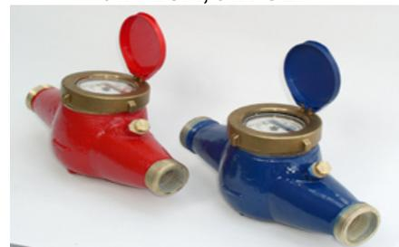
**Счетчики воды крыльчатые ЛК, предназначены для измерения объема протекающей через них питьевой воды или горячей воды в системах горячего водоснабжения протекающей под давлением не более 1 МПа и для температур от 5°C до 30°C и от 30°C до 90°C с поворачиваемым счетным механизмом для удобного считывания в любом положении.**
